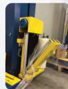
CARRELLO PORTA BOBINA con PRESTIRO 200% e TENSIONAMENTO FISSO
